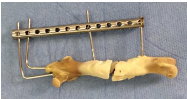
Obr. 3 Femur zajaca s kostným defektom s implantátom z PEEK materiálu
