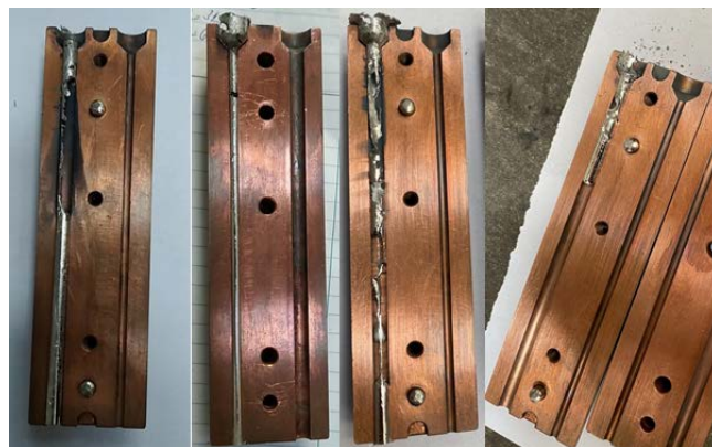
Obr. 2 Odliate vzorky Mg_{66}Ca_{30}Zn_4
