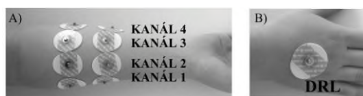
Obr. 2: Umiestnenie elektród: A) snímacie elektródy, B) DRL elektróda.
