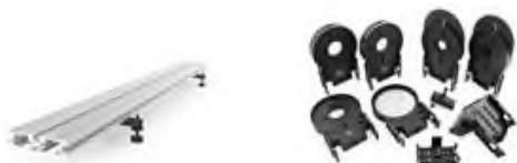
Obr. 3: Vernierová optická lavica spolu so sadou polarizátorov [6, 7]
