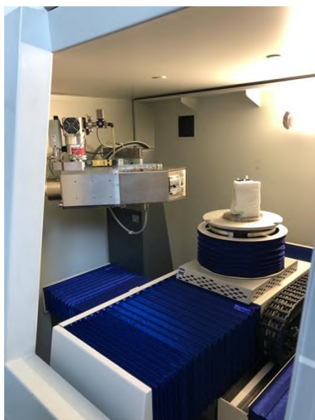
Obr. 5: Snímanie vzoriek na metrotome.
