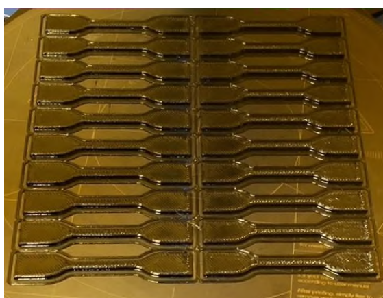
Obr. 3: 3D tlač PETG vzoriek.
