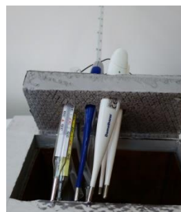
Obr. 4: Elektronické teploměry umístěné v polystyrenovém víku pro zasunutí do vodní lázně
