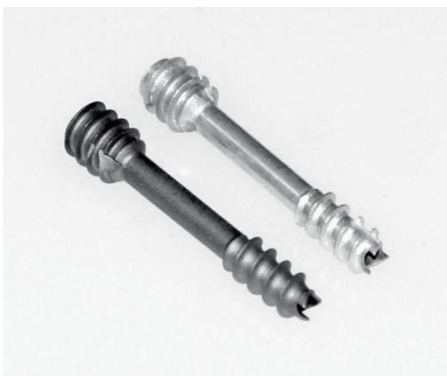
Obr. 2 Titánová skrutka (vľavo) Skrutka Magnezix®(vpravo)
