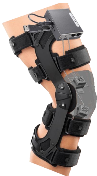
Obr. 1: Model rozmístění modulů mobilního chladicího systému na kolenní ortéze.
