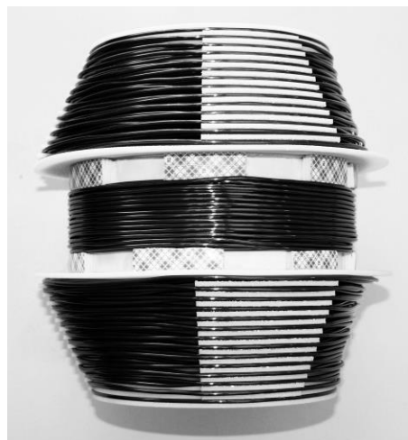
Obr. 2: Expozičná cievka špeciálne navrhnutá pre dosiahnutie homogeneity MP v ožarovanej oblasti
