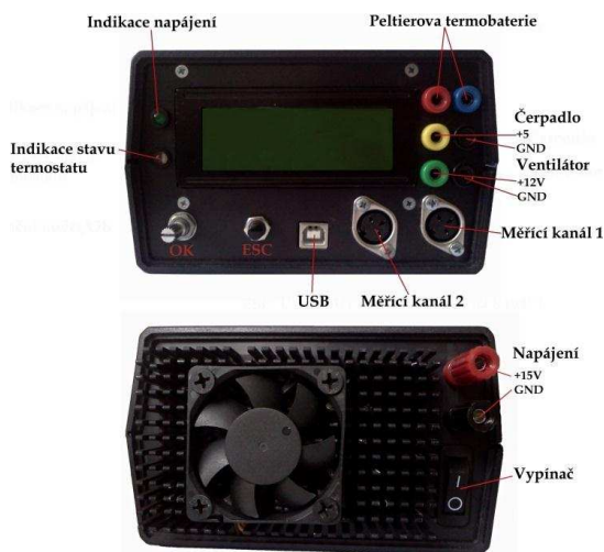
Obr. 5. Popis prvků na panelech zařízení
