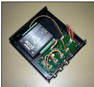
Obr. 2. Modul úpravy signálov a akvizičný modul vo vnútri meracej jednotky BioLab-P.
