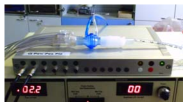
Obr. 1 – HW měřicí část s připojenou clonkou.
