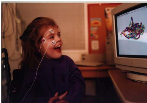
Obr. 7. Systém EagleEyes – snímání očních pohybů pomocí EOG
