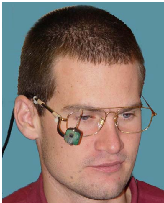
Obr. 9. Systém I4Control ® – snímání očních pohybů pomocí VOG.
