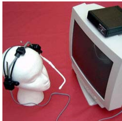
Obr. 5. Emulátor myši HeadMaster.
