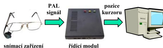
Obr. 10. Základní blokové schéma systému I4Control ® .
