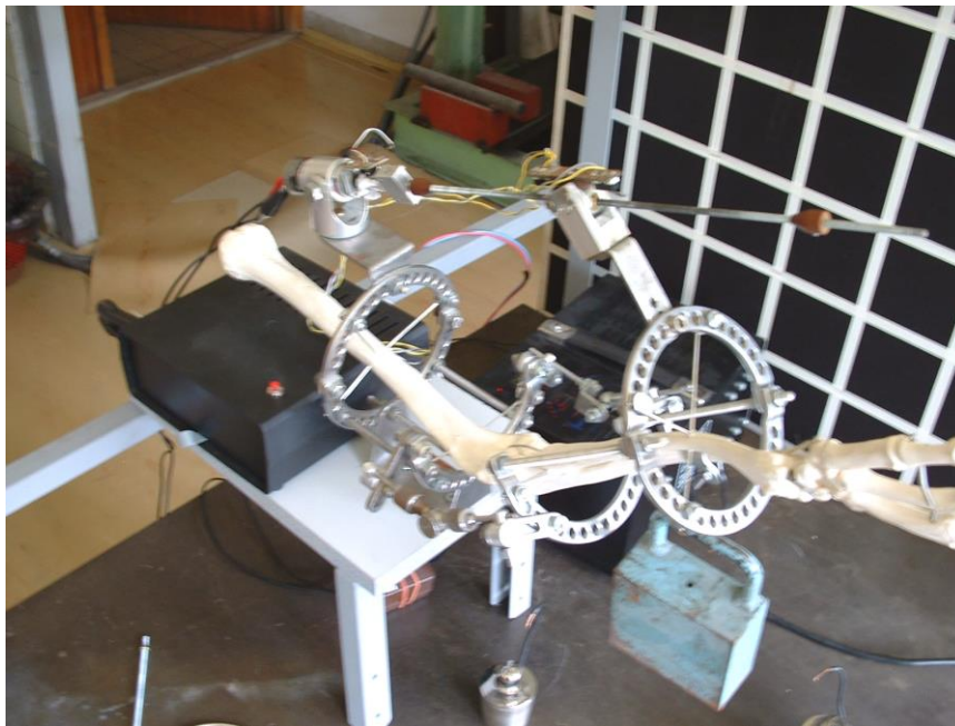
Obr. 4: Test pohonu fixátoru při zavěšeném závaží
